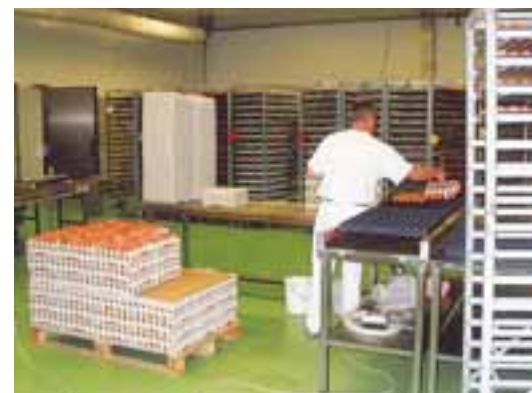
Сжатым воздухом перед инкубацией дезинфицируются сразу все яйца в ячейке
