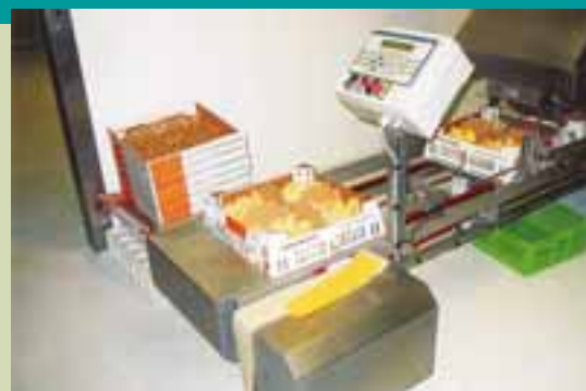
Машина сама считает цыплят и укладывает в коробки для отправки
